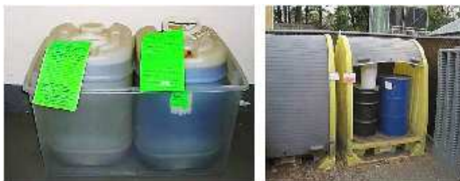
شکل ۴- روش صحیح نگهداری موقت ظروف حاوی مواد شیمیایی
